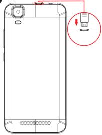
**EN** Insert USB cable and charge for 8 hours **ES** Inserte el cable USB y cargue por 8 horas **PT** Insira o cabo USB e carregue por 8 horas LIV 1
