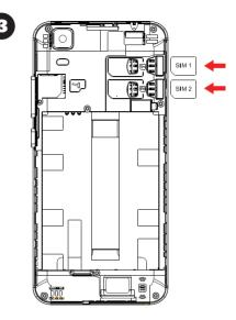
**EN** Insert SIM 1 + SIM 2 ES Inserte SIM 1 + SIM 2
