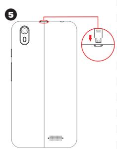
**EN** Insert USB cable and charge for 8 hours **ES** Inserte el cable USB y cargue por 8 horas **PT** Insira o cabo USB e carregue por 8 horas
