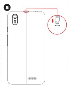
**EN** Insert USB cable and charge for 8 hours **ES** Inserte el cable USB y cargue por 8 horas **PT** Insira o cabo USB e carregue por 8 horas
