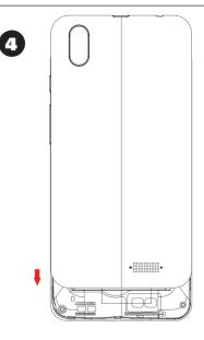
**EN** Replace battery cover **ES** Reponer la cubierta trasera **PT** Fechar a capa de bateria
