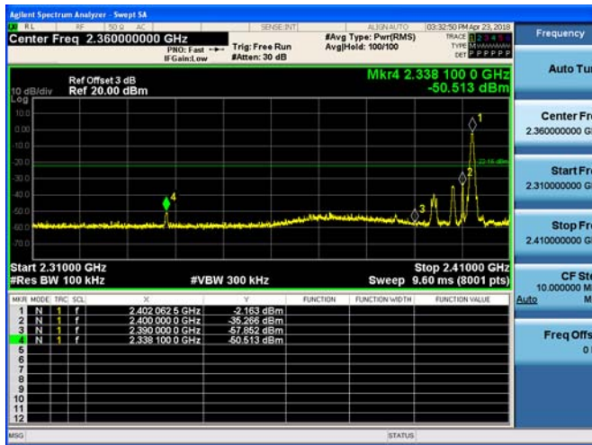
Left Band edge hopping off
