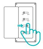
① 设备安装、故障维修请由专业资质电工操作。切勿在设备通电时进行接线操作或触碰到接线端子,以免发生触电危险!
