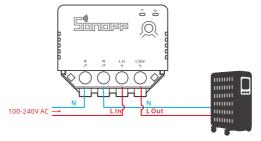
MINIR3 搭配开关伴侣 (S-MATE) 接单火开关示意:
