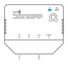
通电后,设备首次使用,默认进入蓝牙配网模式。Wi-Fi指示灯呈"两短一长闪烁"。
