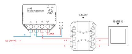
一个 S-MATE 最多可连接一个三通道开关,连接的开关通道与 MINIR3 的控制可一对多、多对一及多对多。 S-MATE 四个端子 (L/L1/L2/L3) 为连通的接线端子,接入 MINIR3 的火线 L 不一定需要从 S-MATE 引出。
