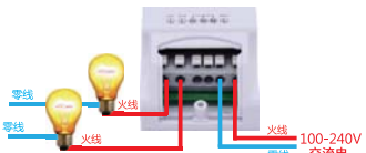
4.2 控制两路单火线开关正确接线方法（比如灯具开关）。
