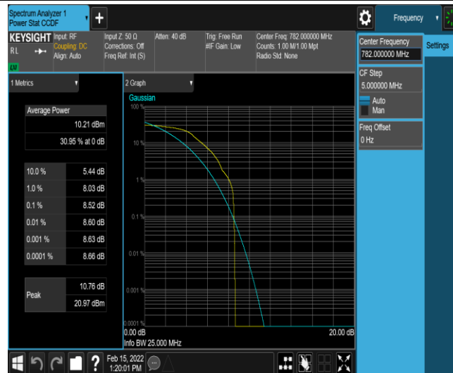
Band13-10MHz-QPSK-23230-1-0-Low-8.52-&lt;=13-PASS
