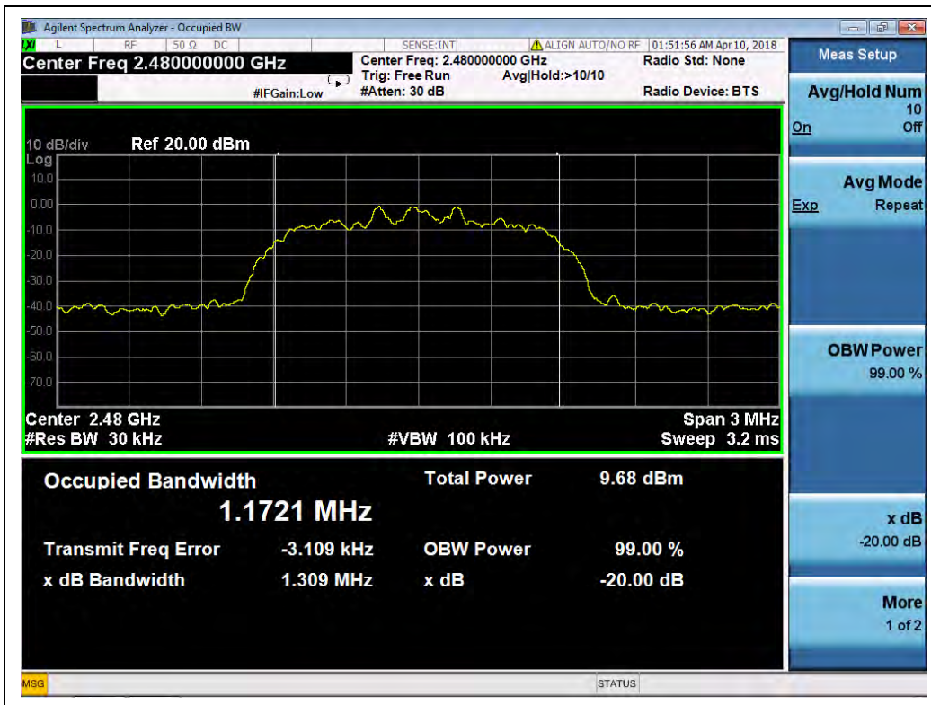
( \pi/4 -DQPSK, Channel 78, 2480MHz)
