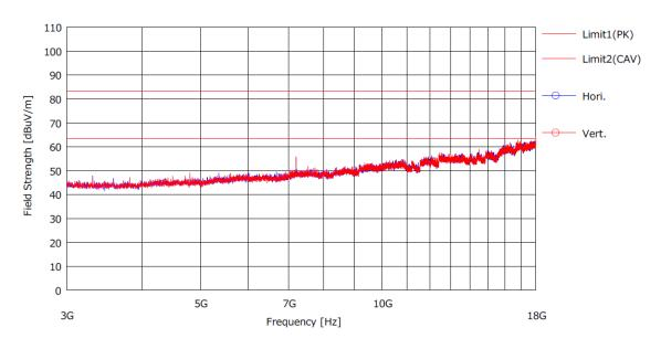
Note 1 : Measured distance : 1 m Note 2 : Limit : Peak : 83.5 dBµV/m Average : 63.5 dBµV/m
