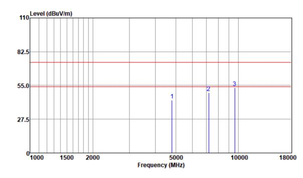
Mode:b; Polarization:Vertical; Modulation:π/4 DQPSK; ; Channel:Low
