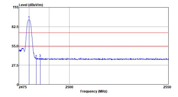
Mode:b; Polarization:Vertical; Modulation:π/4 DQPSK; ; Channel:High
