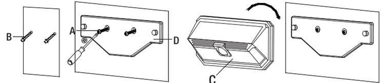
**NOTA:** cuando la luz se active con un movimiento, permanecerá encendida durante 30 segundos. El rango de detección es de 26 pies (unos 8 metros), el ángulo de detección es de 120 °. La luz utiliza la tecnología de radiofrecuencia para la vinculación, por lo cual no debe haber más de 98 pies (unos 30 metros) entre luces adyacentes. **The package include 2 lights. These 2 lights is factory linked, and can not linked any other lights.**
