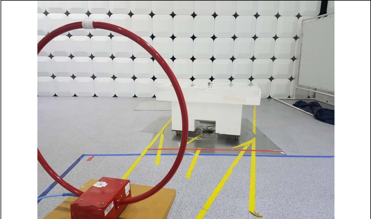
Test distance : 3 m, height of table : 0.8 m
