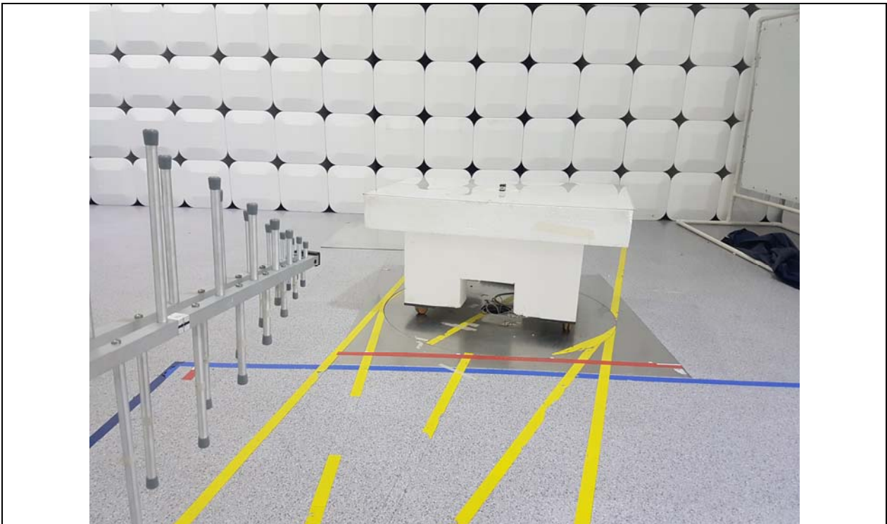
Test distance : 3 m, height of table : 0.8 m
