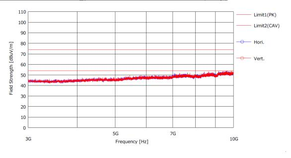
Note 1 : Measured distance : 3 m Note 2 : Limit : Peak : 74.0 dBμV/m Average : 54.0 dBμV/m
