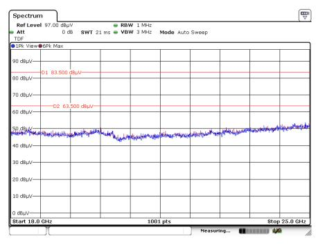
Note 1 : Measured distance : 1 m Note 2 : Limit : Peak : 83.5 dBµV/m Average : 63.5 dBµV/m
