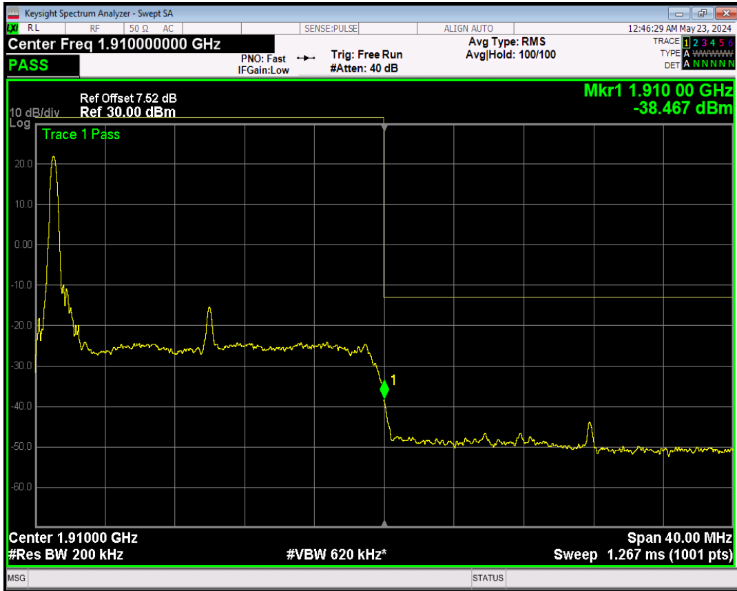
Band2 QPSK BW=20MHz Channel=18700 RB Size=1 Position=#0
