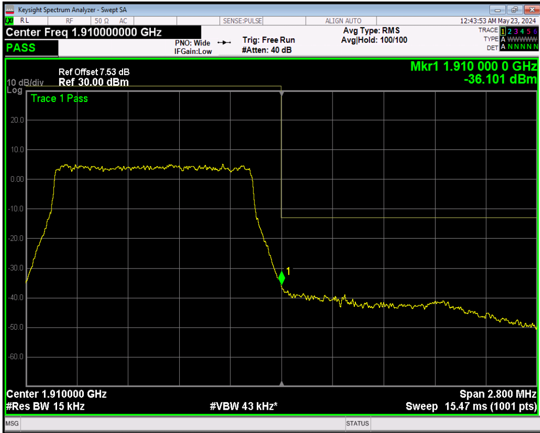
Band2 QPSK BW=10MHz Channel=18650 RB Size=1 Position=#0
