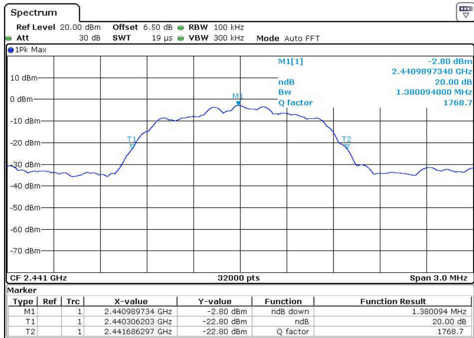
Modulation Standard:  $\pi/4$ -DQPSK
