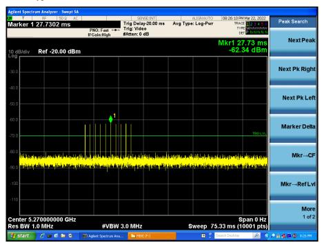
Radar Type 0 (40MHz / 5510MHz)
