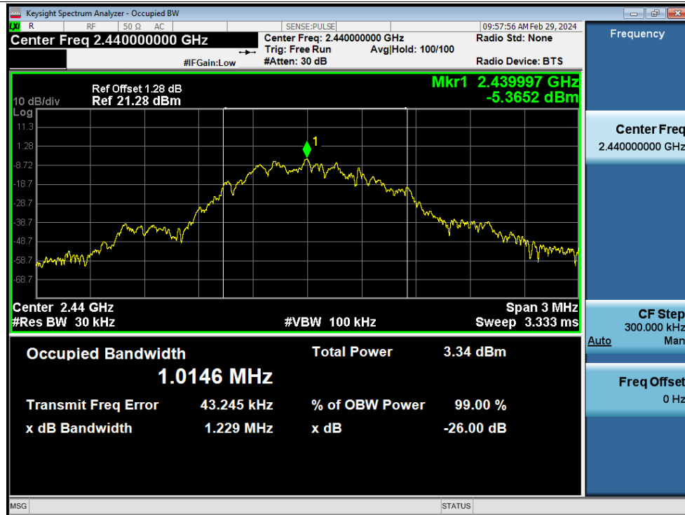
OBW NVNT BLE 1M 2440MHz Ant1
