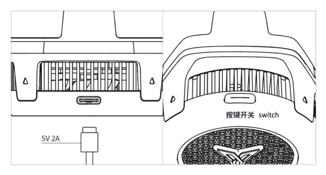
1.初次使用,接通电源即开启散热器的智能变频模式;确保充电器的输出功率为5V 2A或以上。 1. First to use: The default mode is the Smart Frequency Conversion mode. Notice: 5V 2A or higher charger output is required. 2.按键开关:单击可控制开启或关闭散热器。 2.Power Switch: Click can control the cooling fan on and off
