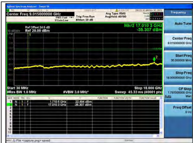
Band66 / 1.4MHz / Low CH / QPSK
