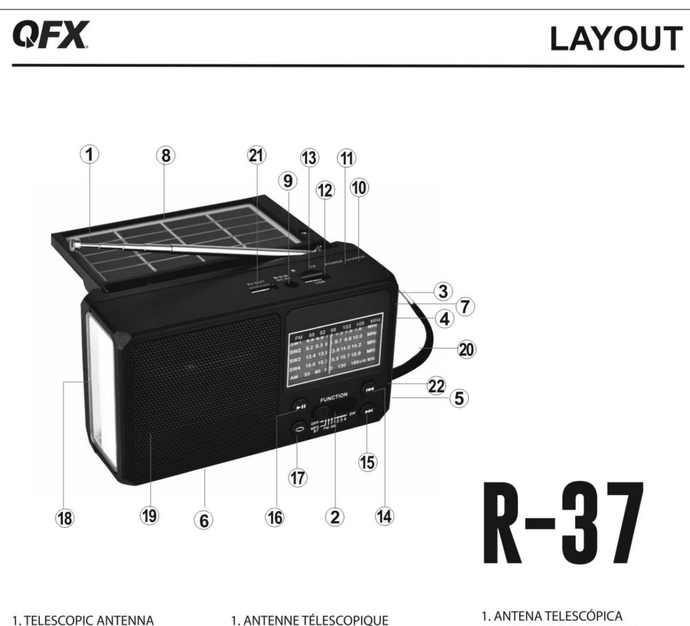
2. BAND SWITCH 3. TUNING KNOB 4. VOLUME CONTROL 5. LIGHT ON/OFF BUTTON 6. BATTERY COMPARTMENT 7. HEADPHONES JACK 8. SOLAR PANEL 9. DC 5V INPUT/ CHARGE 10. CHARGE INDICATOR LIGHT 11. POWER INDICATOR LIGHT
