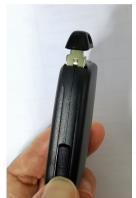
第二步, 用备用钥匙插入钥匙壳顶部的凹入部位,稍微用力转动备用钥匙,就可以 把这个遥控打开。
