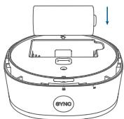
3. Volte a colocar a tampa do compartimento da bateria e rode no sentido dos ponteiros do relógio para a bloquear. Alinhe cuidadosamente as marcas.
