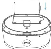
3. Bringen Sie die Batteriefachabdeckung wieder an und drehen Sie sie im Uhrzeigersinn, um sie zu verriegeln. Richten Sie die Markierungen sorgfältig aus.
