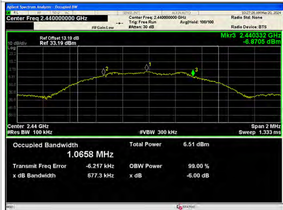
-6dB Bandwidth NVNT BLE 1M 2440MHz Ant1
