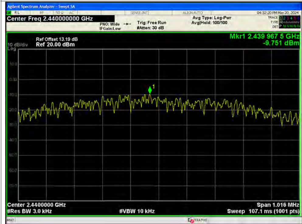
PSD NVNT BLE 1M 2440MHz Ant1
