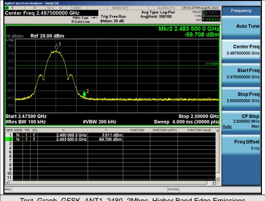
Test\_Graph\_GFSK\_ANT1\_2480\_2Mbps\_Higher Band Edge Emissions
