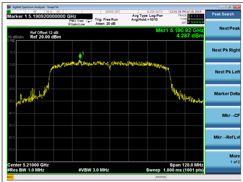
(Channel 42, 5210MHz, 802.11ac (VHT80))
