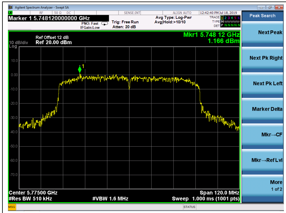
(Channel 155, 5775MHz, 802.11 ac (VHT80))
