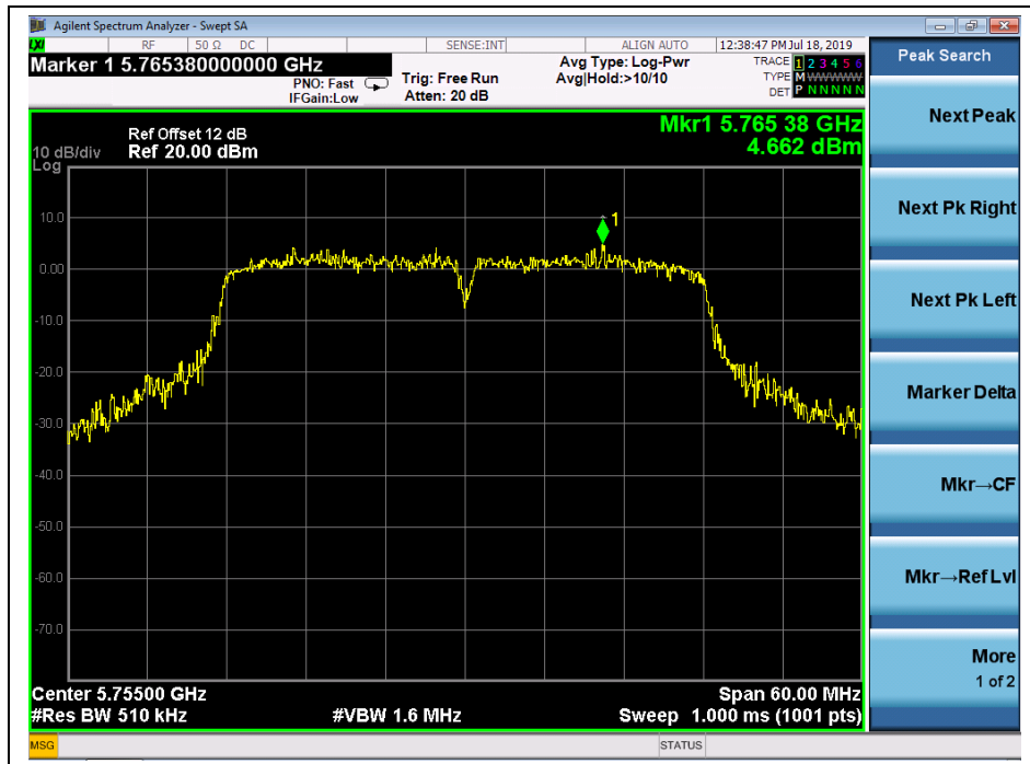
(Channel 151, 5755MHz, 802.11 ac (VHT40))
