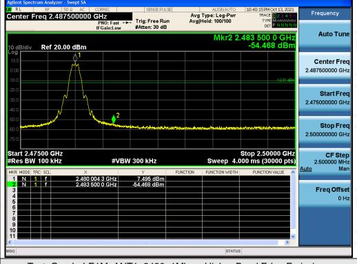
Test\_Graph\_LE1M\_ANT1\_2480\_1Mbps\_Higher Band Edge Emissions
