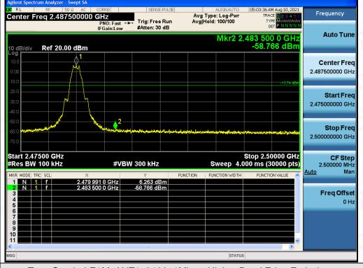
Test\_Graph\_LE1M\_ANT1\_2480\_1Mbps\_Higher Band Edge Emissions
