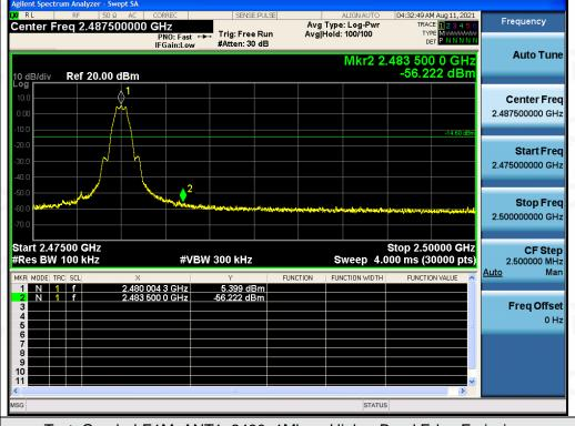
Test\_Graph\_LE1M\_ANT1\_2480\_1Mbps\_Higher Band Edge Emissions
