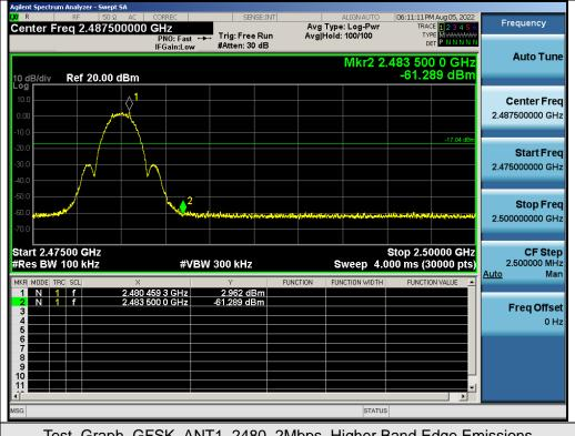
Test\_Graph\_GFSK\_ANT1\_2480\_2Mbps\_Higher Band Edge Emissions
