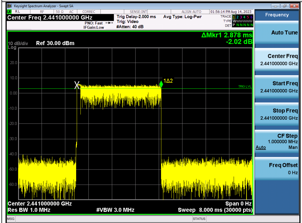
Test_Graph_EDR_HOP_ANT1_NA_3Mbps_2441_Time per Burst
