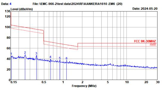
Data no. : 4 Ant. pol. : COAXIAL Site no. : 2# 966 chamber Dis. / Ant. : 3m FMZB 1519B
