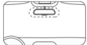
メモ:静電防止ラベルはフロントガラスの平らな部分に貼り付け、強く押して、フロントガラスフィルムの端に貼り付けないようにして、落下しないようにしてく。
