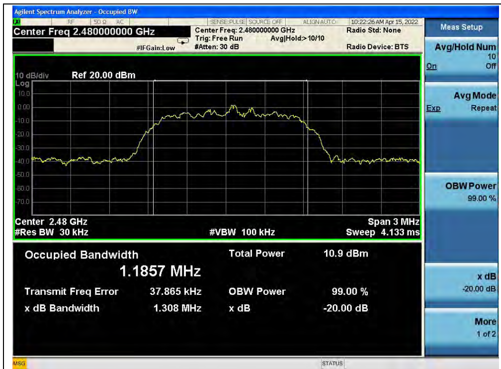
(Channel 78, \pi/4 -DQPSK)
