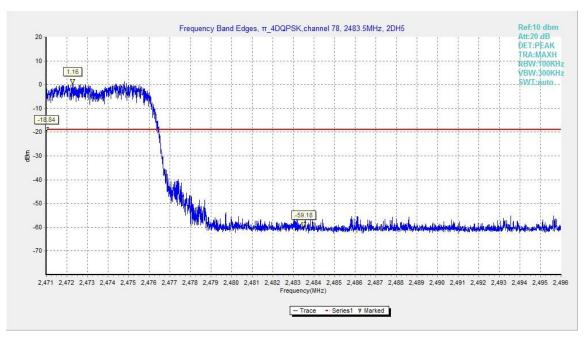
Fig.8. Frequency Band Edges: π/4 DQPSK, Channel 78, Hopping On
