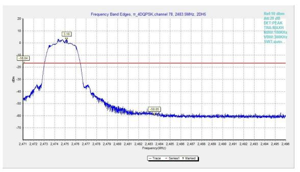
Fig.7. Frequency Band Edges: π/4 DQPSK, Channel 78, Hopping Off
