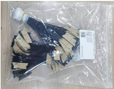
图 1: 一扎端子头用泡棉 包扎后装 入PE 袋, 每袋 200/PCS
