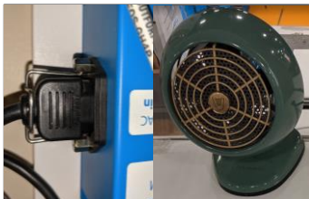
K1 Fan Relay & Fan
