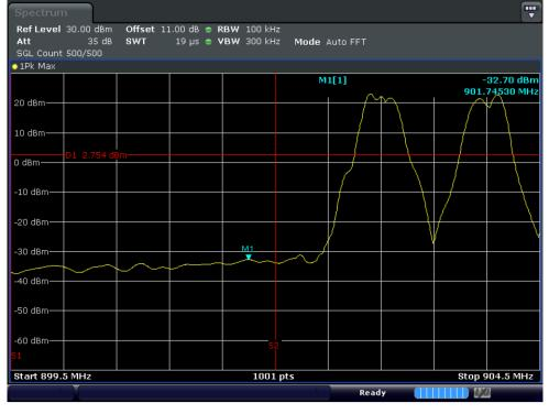
Note 1 : Reference : 22.75 dBm Limit : 22.75 dBm - 20 dB = 2.75 dBm
