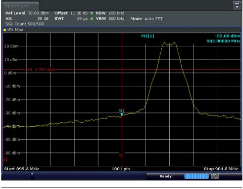
Note 1 : Reference : 22.75 dBm Limit : 22.75 dBm - 20 dB = 2.75 dBm
