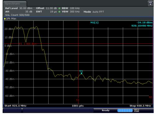
Note 1 : Reference : 22.40 dBm Limit : 22.40 dBm - 20 dB = 2.40 dBm
