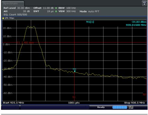
Note 1 : Reference : 22.40 dBm Limit : 22.40 dBm - 20 dB = 2.40 dBm
