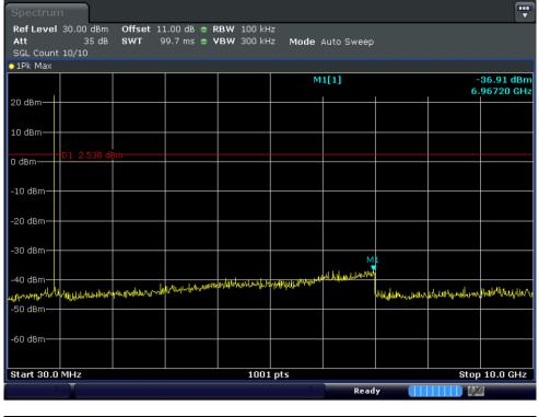
Note 1 : Reference : 22.54 dBm Limit : 22.54 dBm - 20 dB = 2.54 dBm
