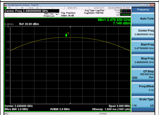
\pi/4 DQPSK Output power - High CH 2480
