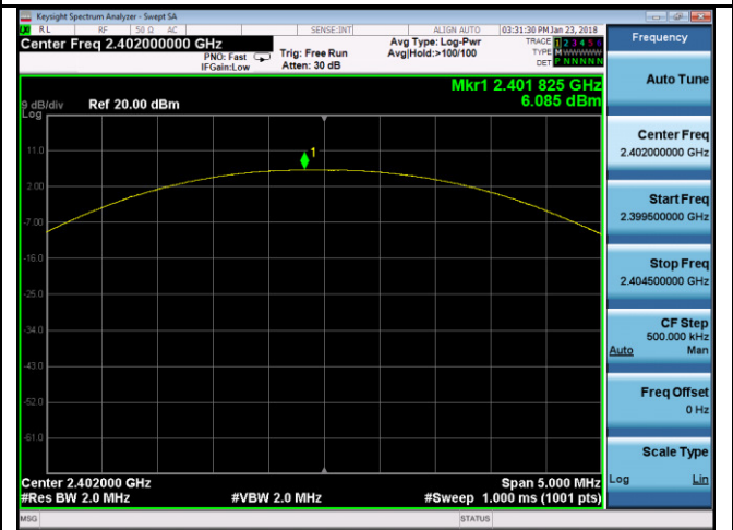
\pi/4 DQPSK Output power - Low CH 2402
