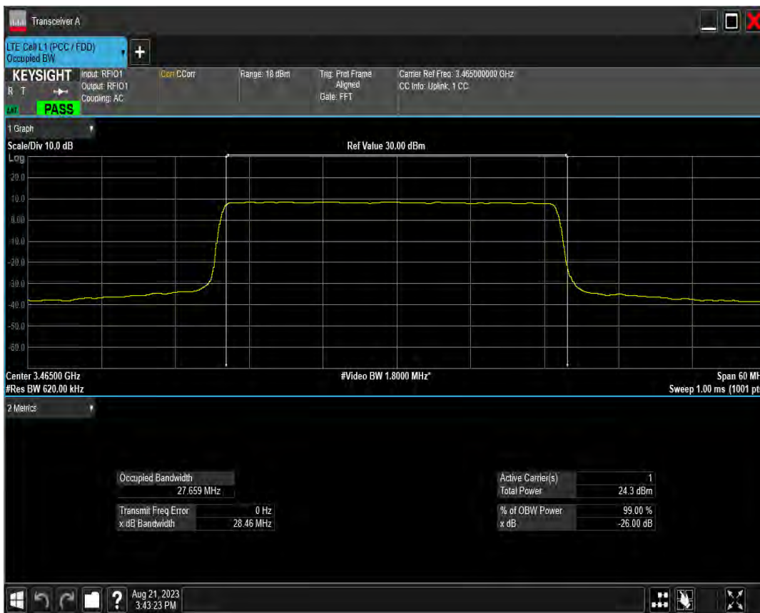
n78(3450-3550) SCS=30kHz DFT QPSK BW=20MHz Channel=636000 RB=50@0
