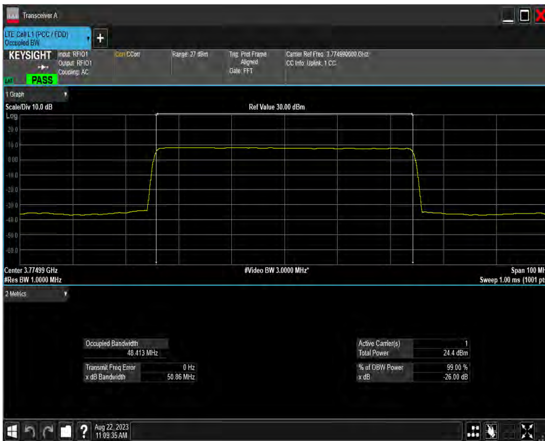
n78(3700-3800) SCS=15kHz DFT QPSK BW=10MHz Channel=647000 RB=50@0
