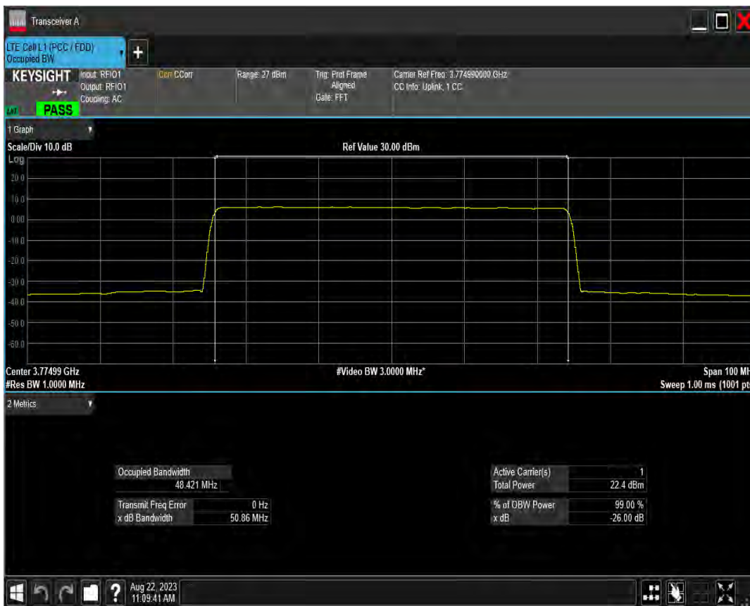
n78(3700-3800) SCS=15kHz DFT BPSK BW=10MHz Channel=647000 RB=50@0
