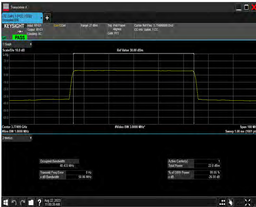
n78(3700-3800) SCS=15kHz DFT 256QAM BW=10MHz Channel=647000 RB=50@0
