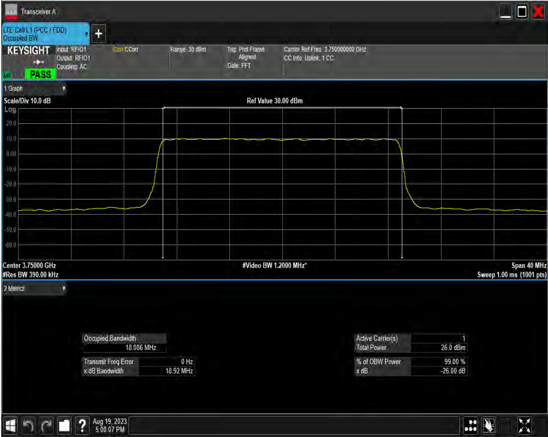
n78(3700-3800) SCS=30kHz DFT 256QAM BW=20MHz Channel=647334 RB=50@0
