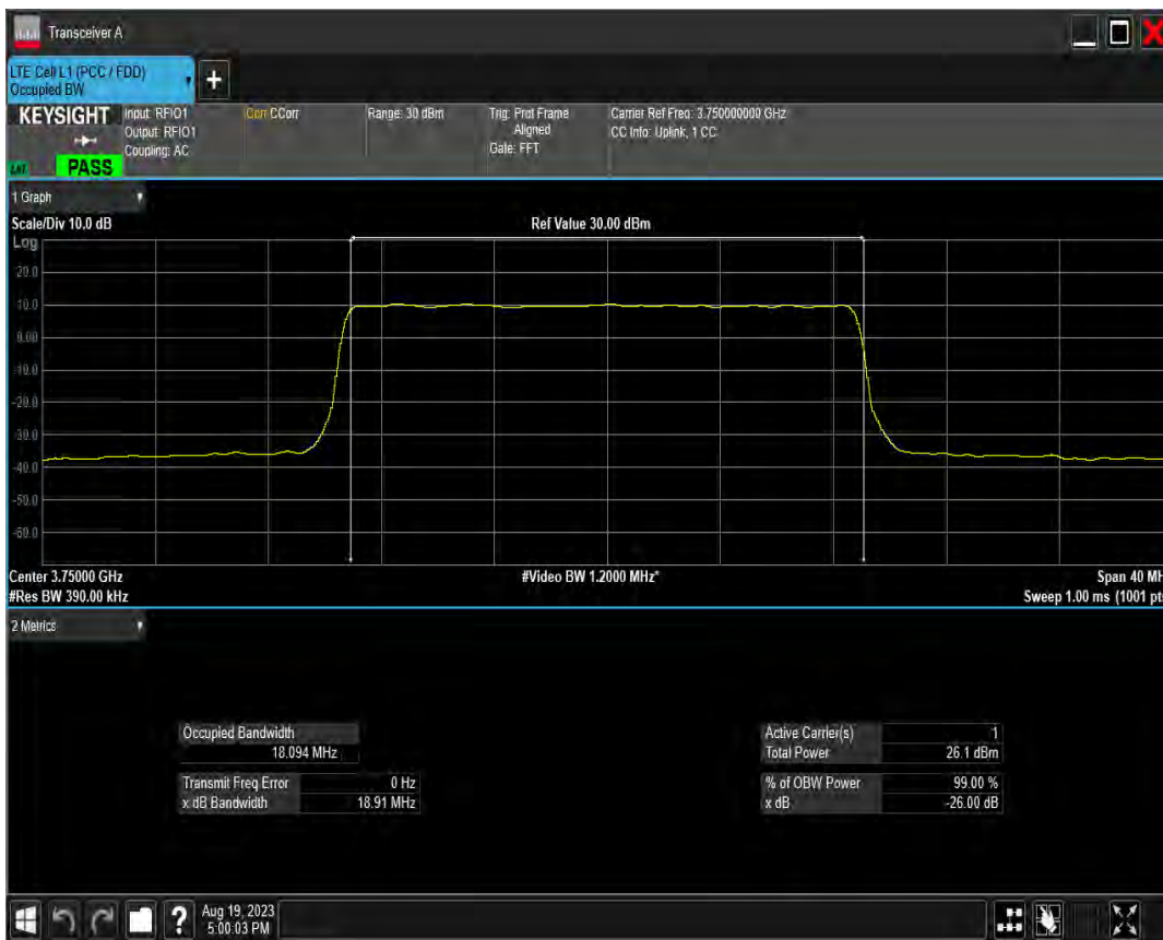
n78(3700-3800) SCS=30kHz DFT 64QAM BW=20MHz Channel=652666 RB=50@0
