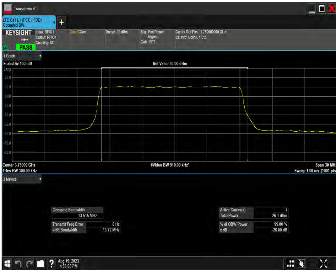
n78(3700-3800) SCS=30kHz DFT 256QAM BW=20MHz Channel=652666 RB=50@0
