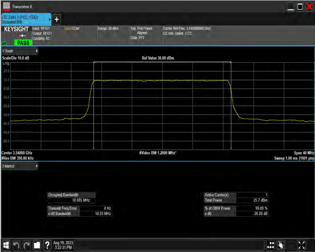
n78(3450-3550) SCS=30kHz DFT QPSK BW=20MHz Channel=633334 RB=50@0
