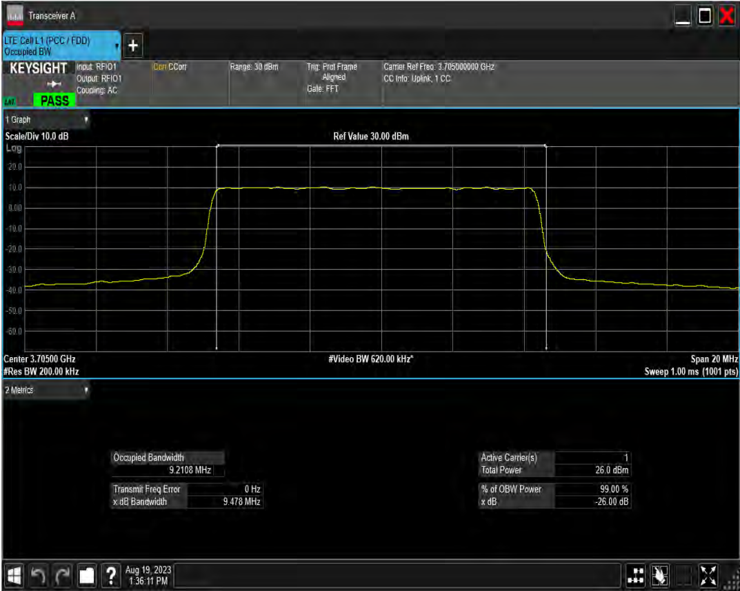
n78(3700-3800) SCS=15kHz DFT 64QAM BW=10MHz Channel=650000 RB=50@0
