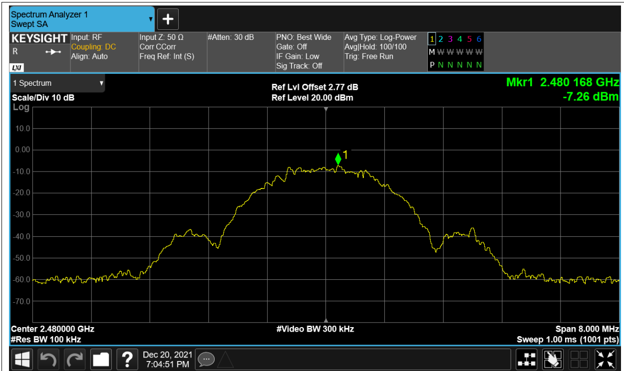
Band Edge NVNT BLE 2480MHz Ant1 Emission
