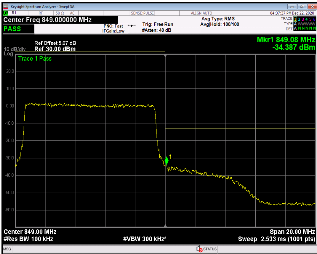
n5 SCS=30kHz CP_QPSK BW=15MHz Channel=166300 RB=1@0
