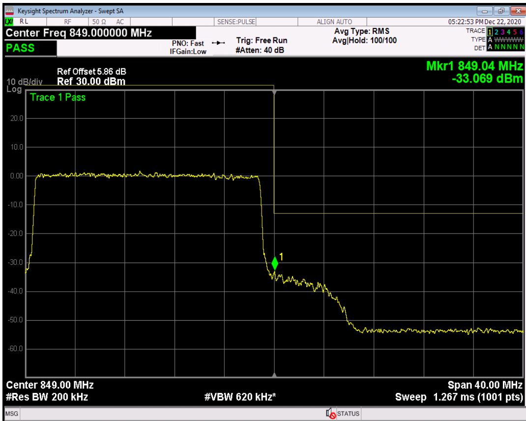
n5 SCS=30kHz CP_QPSK BW=20MHz Channel=167800 RB=50@0
