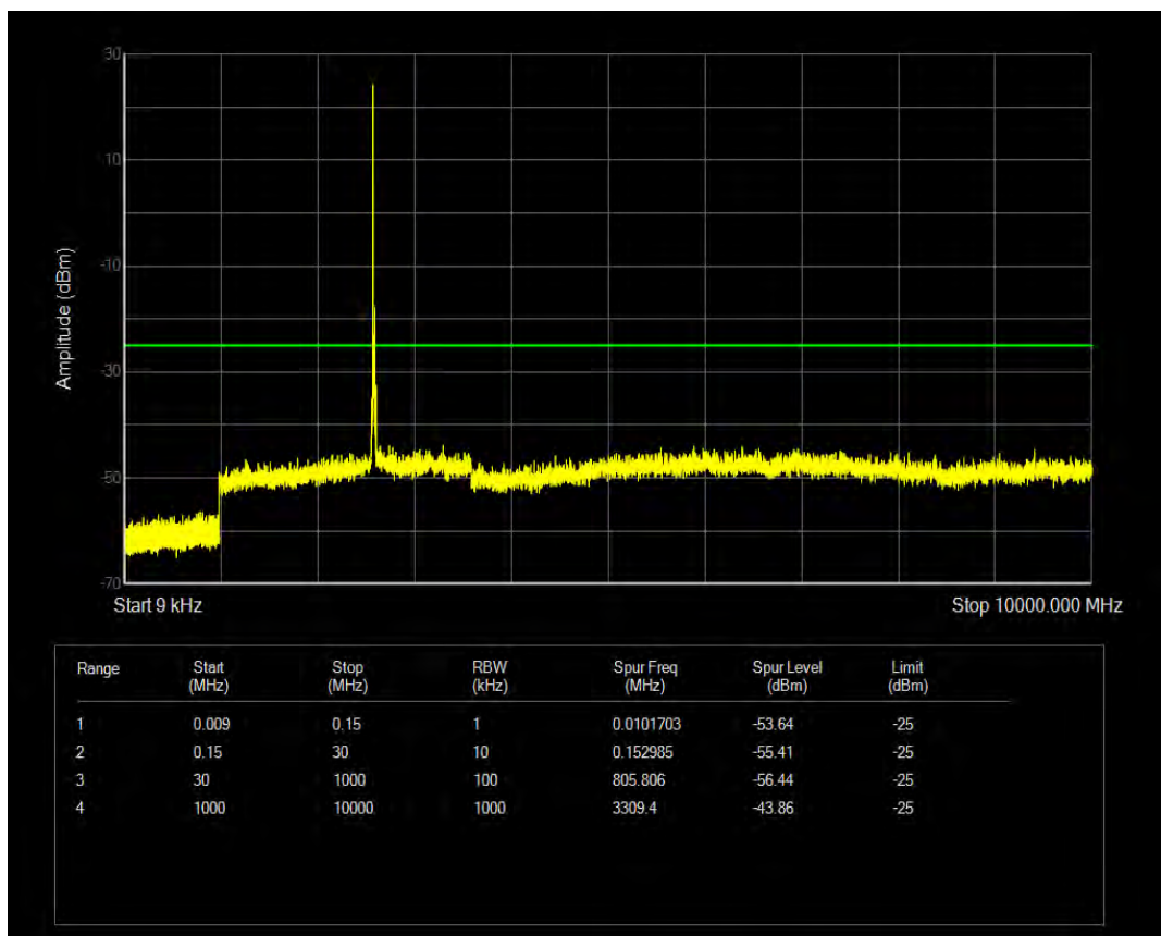
n41 SCS=30kHz CP_QPSK BW=15MHz Channel=518598 RB=1@37
