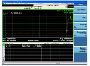
$\pi$  /4-DQPSK: Band Edge-High Channel
