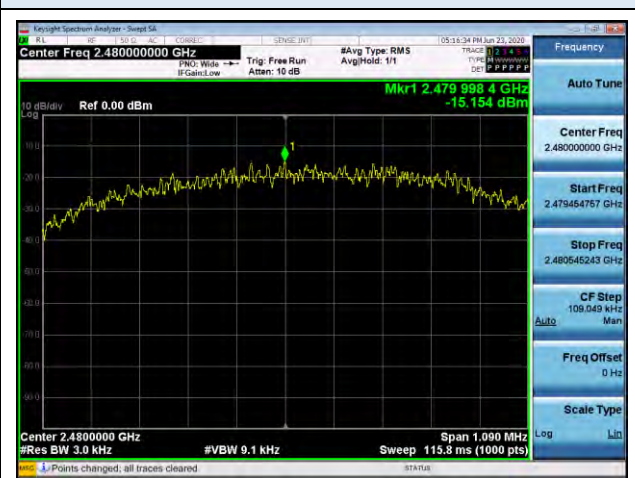
BLE 1M (MESH) : CH 39 (2480 MHz)
