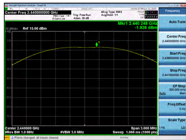
BLE 1M (MESH) : CH 39 (2480 MHz)
