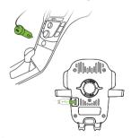
Das Easy One Touch Wireless wird über ein Micro-USB-Kabel mit Strom versorgt. Easy One Touch Wireless verfügt nicht über einen Ein-/Ausschalter. Sobald das Gerät an die Stromquelle angeschlossen ist, bleibt es eingeschaltet.
