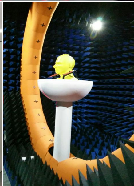
3座远场3D全电波微波暗室实验室系统，1座MVG SG24LT (Satmio) 近场3D微波暗室实验室系统（与国家相关实验室同步）
