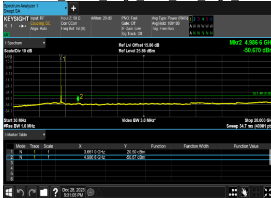
N48(40M)_DFT-s-OFDM BPSK Edge 1RB Left High CH
