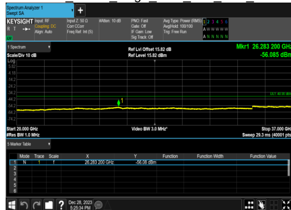
N48(40M)_DFT-s-OFDM BPSK Edge 1RB Left Low CH
