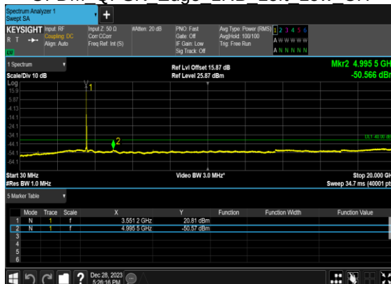
N48(40M)_DFT-s-OFDM QPSK Edge 1RB Left Low CH
