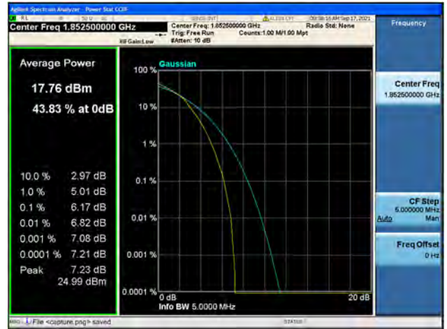
Band2 / 5MHz / Mid CH / QPSK
