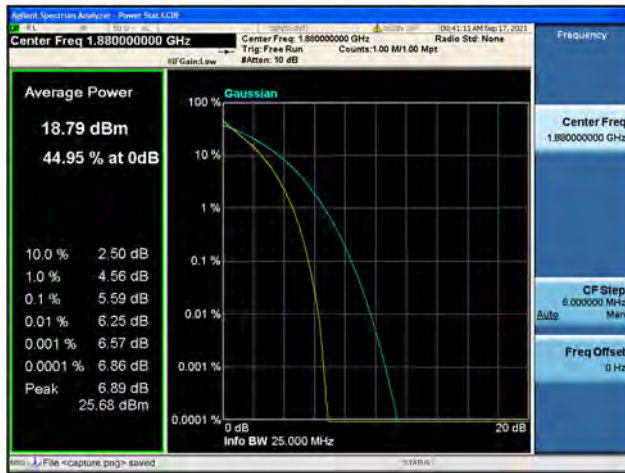
Band2 / 20MHz / Mid CH / 64QAM
