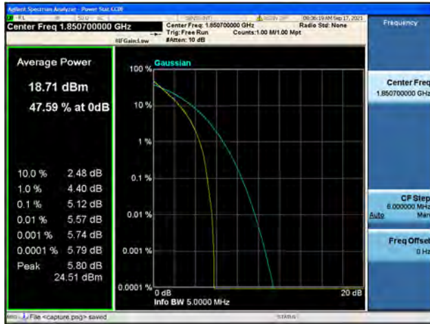
Band2 / 1.4MHz / Low CH / 64QAM
