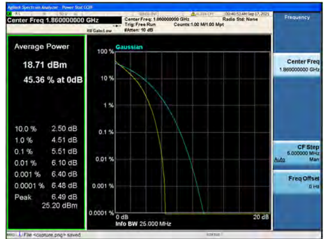
Band2 / 20MHz / Low CH / 64QAM
