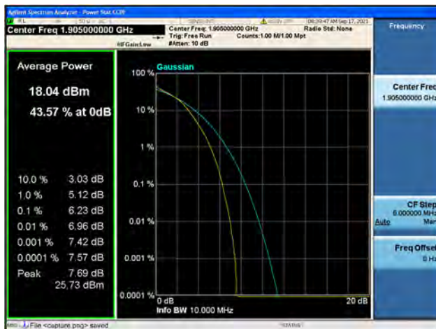
Band2 / 10MHz / High CH / 16QAM
