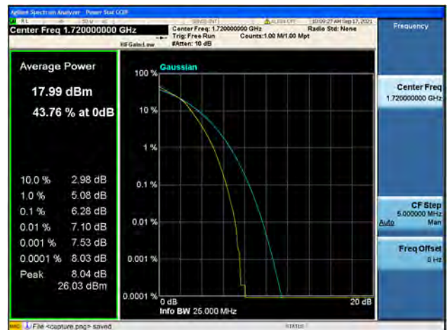
Band4 / 20MHz / Low CH / 64QAM
