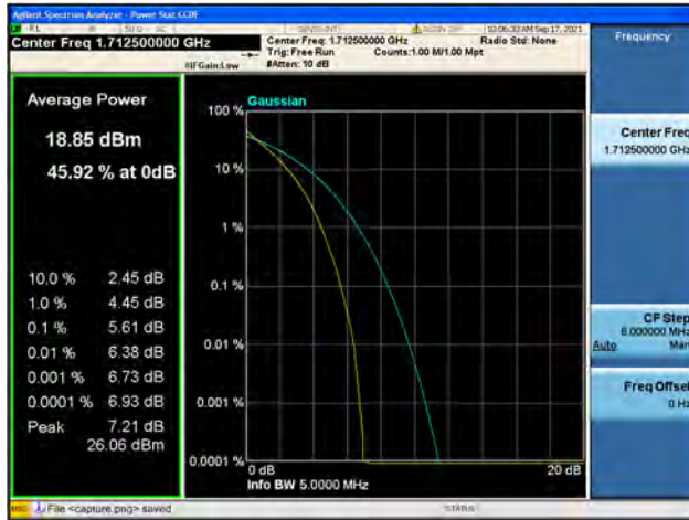
Band4 / 5MHz / Low CH / 64QAM
