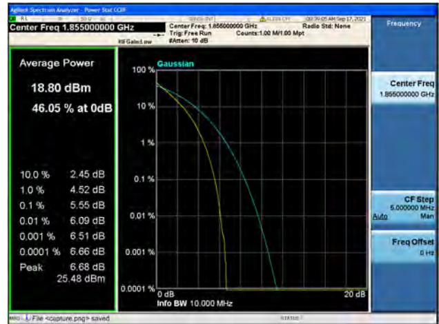
Band2 / 10MHz / Low CH / 64QAM
