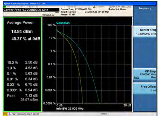
Band4 / 20MHz / Low CH / 64QAM
