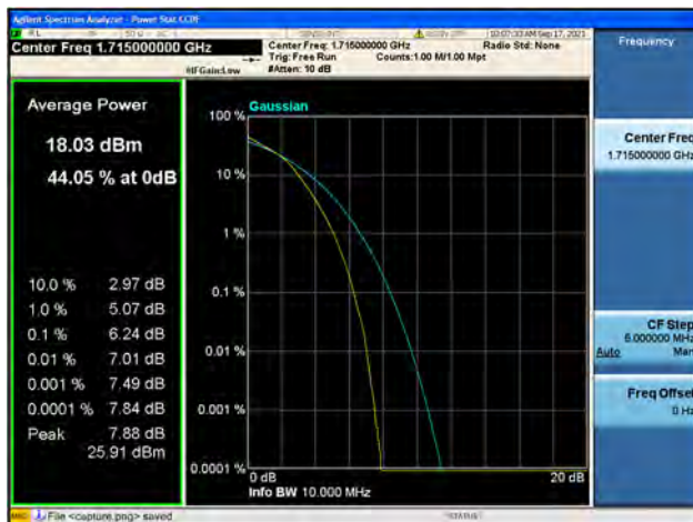
Band4 / 10MHz / Low CH / 16QAM
