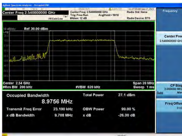
Band41 / 10MHz / Low CH / 16QAM
