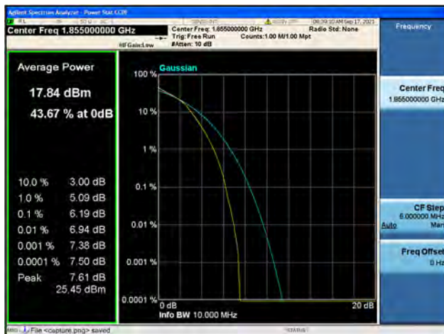
Band2 / 10MHz / Low CH / 16QAM
