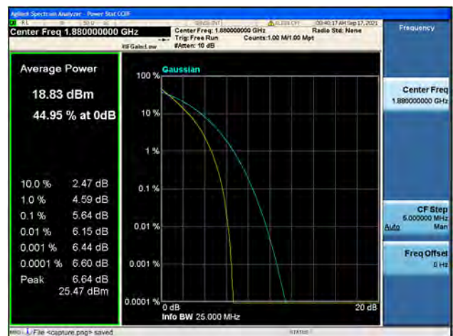
Band2 / 15MHz / Mid CH / 64QAM
