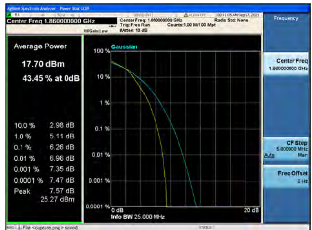
Band2 / 20MHz / Low CH / 64QAM
