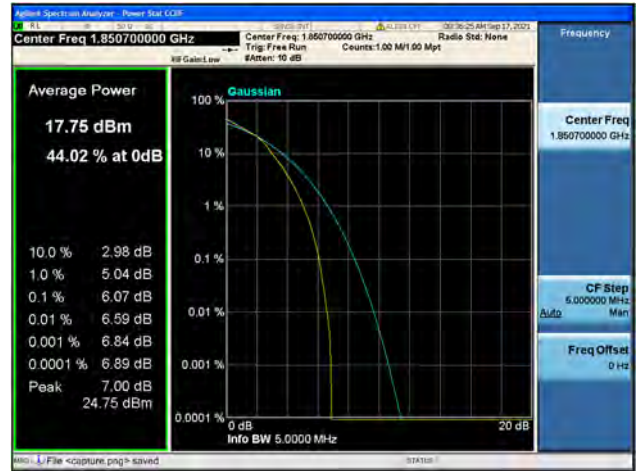
Band2 / 1.4MHz / Mid CH / QPSK
